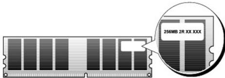
**ANMERKUNG:** Installieren Sie DDR2-Speichermodule immer in der auf der Systemplatine angegebenen Reihenfolge.
